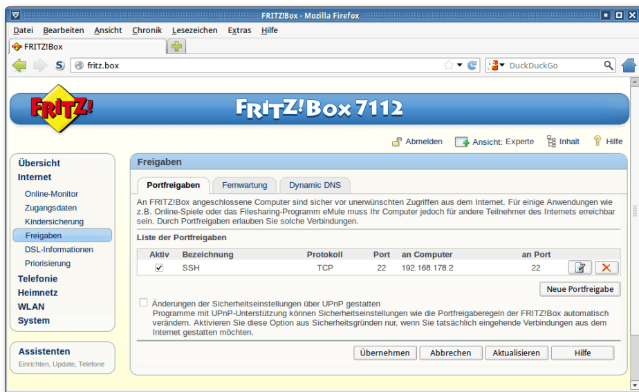
Portweiterleitung in der FRITZ!Box. 🔍
